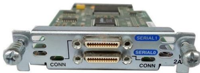
г) Cisco WIC-2A/S (2 последовних інтерфейси, роз'єм Smart Serial)
