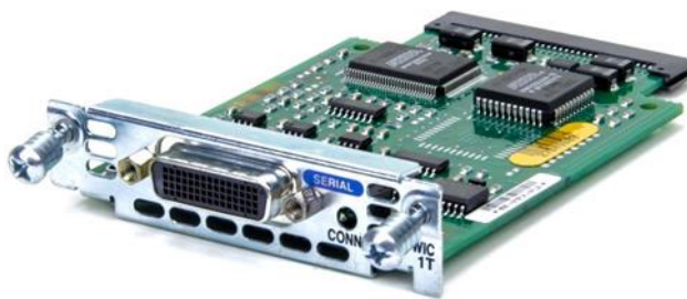
а) Cisco WIC-1T (последовний інтерфейс, роз'єм V.35)
