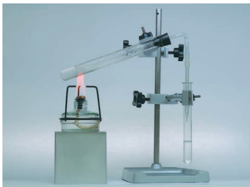
Мал. 21.2. Одержання етанової кислоти в лабораторії
