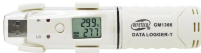
Рис. 4.64. Логер із можливістю підключення до ПК через USB
